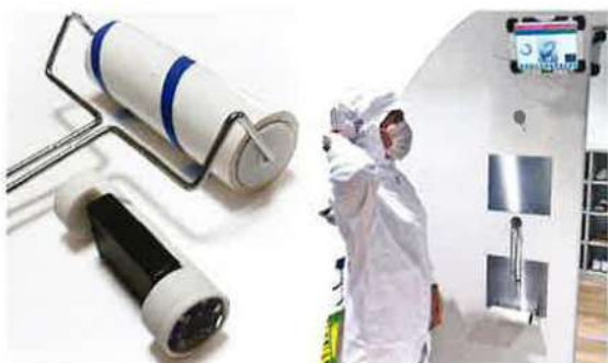
粘着ローラー本体（筒内部）「コロコロチェッカー」の設置例 に三軸センサーを搭載
