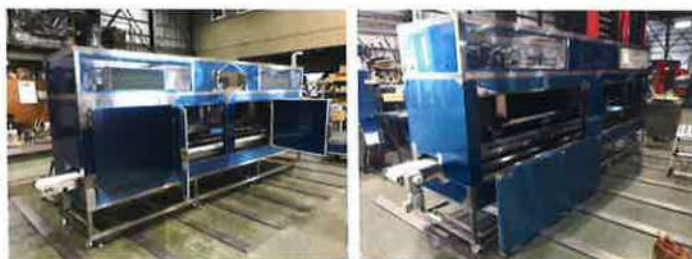
「チルドコンベア冷却タイプ」の正面(観音扉)と背面(脱着パネル)に大きな点検口がついている
