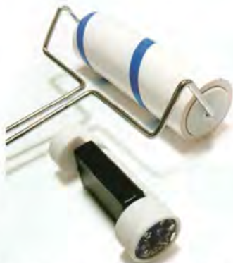
粘着ローラーと回転を検知するセンサー
