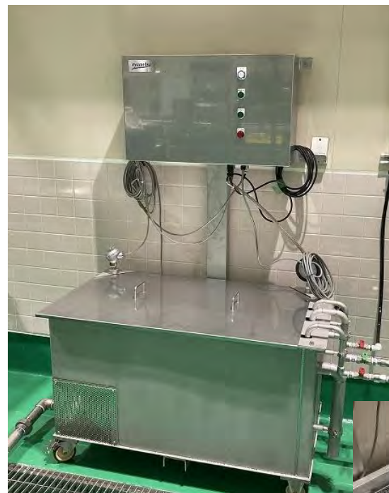
乳酸菌飲料充填工場（岡山県） オーダーメイド投込み式超音波洗浄機
