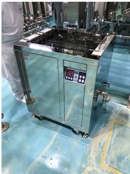
乳酸菌飲料充填工場（岡山県） 100L超音波洗浄機
